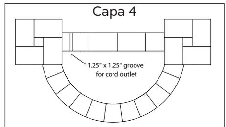
Continúe colocando piedras hasta que las paredes de la cuenca estén cubiertas completamente (capas 2 y 3). Deje un orificio de 1/4" x 1/4" / 31mm x 31mm para el cable de la bomba y pase el cable (capa 4).
