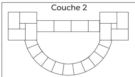
Posez le bassin raccordé en position avec le PVC flexible de 1/2" et la ligne d'alimentation de remplissage automatique optionnelle alimentant l'arrière du bassin à travers les encoches. Posez la ligne inférieure de pierres de mur le long de l'arrière du bassin en laissant un espace pour le PVC flexible de 1/2" et le tuyau de source d'eau pour le remplissage automatique (si nécessaire). Continuez avec une couche de pierres autour de l'avant du bassin (couche 1).
