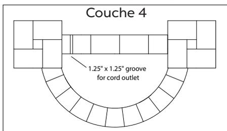
Continuez à poser les pierres jusqu'à ce que les parois du bassin soient complètement couvertes (couches 2-3). Laissez un trou de 1/4" x 1/4"/32 x 32mm pour le cordon de la pompe et faites passer le cordon (couche 4).
