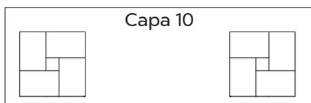
Termine las columnas hasta la altura deseada (capa 10). Tape las salidas de agua con la hilera final de piedras.
