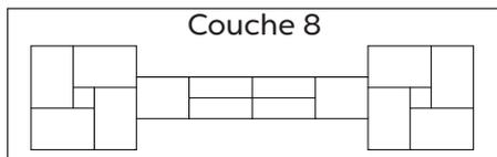
Les niveaux suivants accueilleront l'option de déversoir choisie. Colorfalls et Colorfalls à changements de couleur aura besoin d'encoches prêtes à accueillir la base du Colorfalls et le bec. Les déversoirs en acier inoxydable et en cuivre remplacent les blocs de 4"/102mm; laissez un bloc de 12"/305mm pour le déversoir de 12"/305mm, deux pour le déversoir de 24"/610mm, etc. (couches 7-9). Veuillez consulter les instructions du déversoir pour plus de détails.
